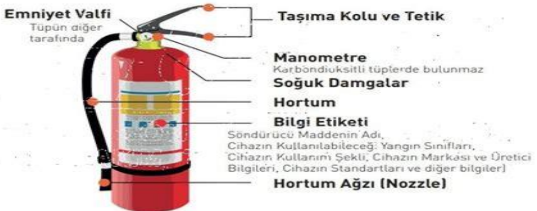
Şekil 6 Yangın Söndürücü Cihazın Tanıtımı
