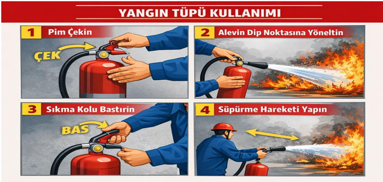
Şekil 7 Yangın Söndürücü Cihaz Kullanımı
